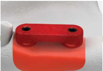
Изготовление позиционирующего шаблона
