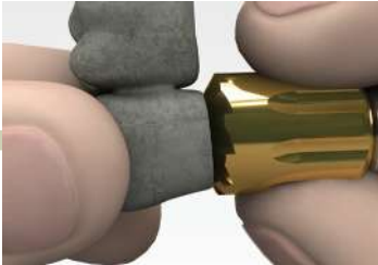
Рассверливание кромки каркаса римером
