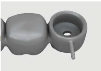
На отлитом металлическом каркасе необходимо удалить кромку
